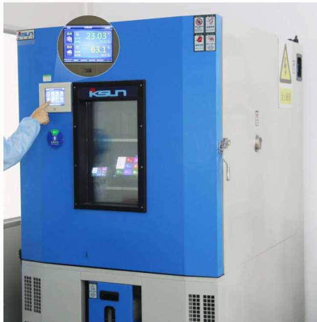
图 3-3 高低温老化测试图
