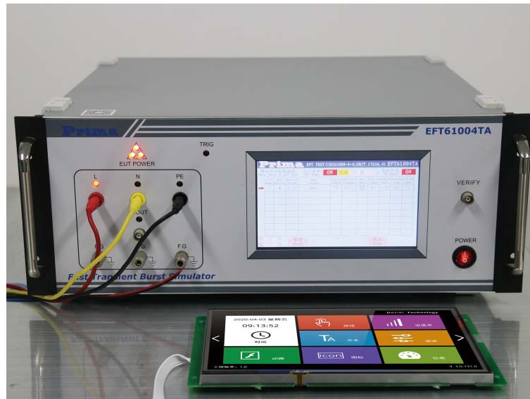
图 3-4 群脉冲测试图
